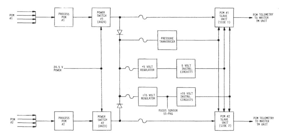
Figure 4.2-4. Instrumentation Subsystem
