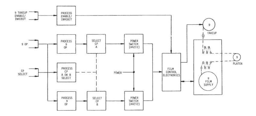
Figure 4.2-11. 9 Film Handling Subsystem
